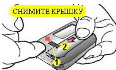
Для замены батареи питания откройте крышку батарейного отсека с обратной стороны пульта, как показано на рисунке – сначала сдвинув замок, а затем сдвинув крышку в сторону кольца для ключей. Выньте старый элемент, затем вставьте новый, соблюдая полярность подключения. Закройте крышку в обратной последовательности.
