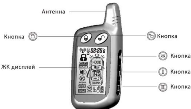
Двусторонний пульт представляет собой миниатюрное приемо-передающее устройство с питанием от 1,5 вольтовой батарейки (типа LR03 AAA), которой, в зависимости от интенсивности использования пульта, хватает на срок от 1 до 6 месяцев. При установке новой батареи индикатор её заряда
