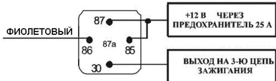
**Разъём S3** – силовой, управления центральным замком:
