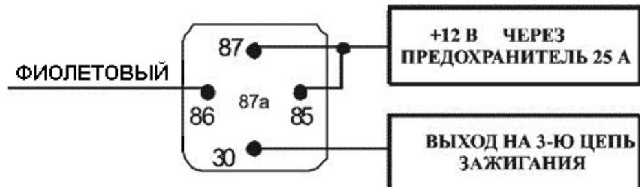
**Разъём S3** – силовой, управления центральным замком:
