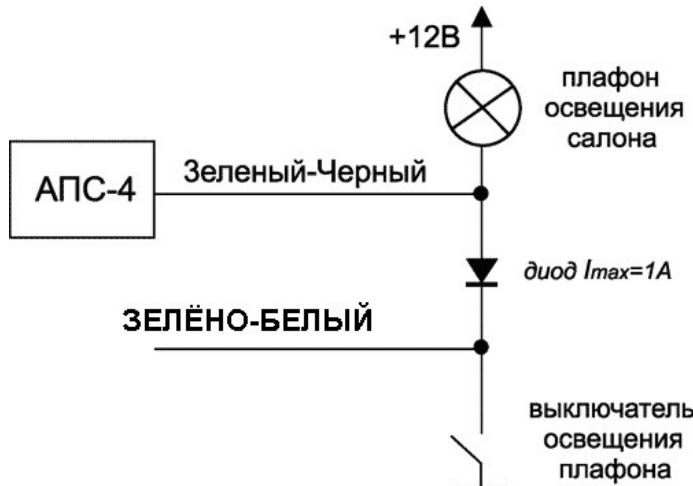
2. Рекомендуемая схема подключения зелёно-белого провода системы («отрицательный триггер двери») к проводке автомобилей ВАЗ семейств 2110 и 2115, оснащенных иммобилайзерами АПС-4:
