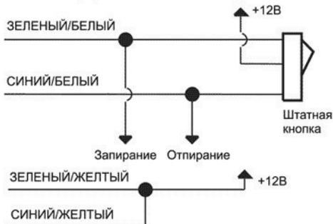
3-проводная система центрального замка с управлением по минусу на автомобилях со штатной сигнализацией или с защитой от случайного отпираения дверей детьми
