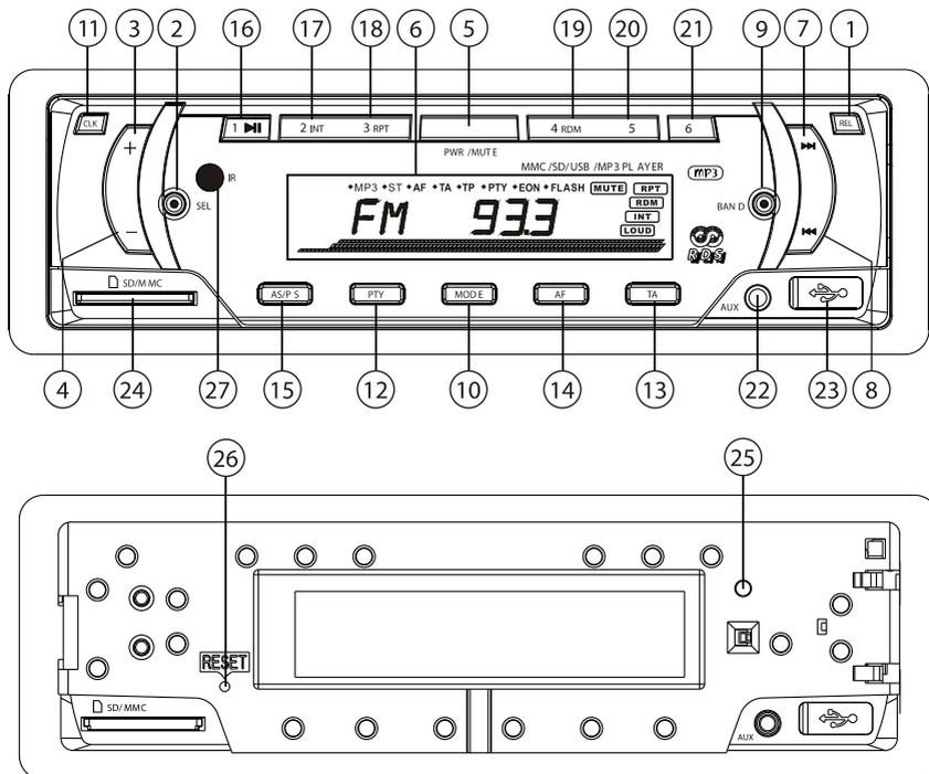
1. REL Кнопка снятия передней панели
