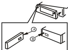
1. Установите в проигрыватель сначала левый край передней панели так, чтобы отметка В на головном устройстве совпала с отметкой А на передней панели (см. рис.).
