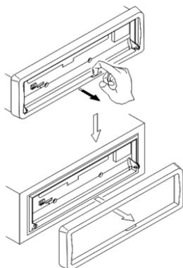
2. Вставьте до упора ключи, входящие в комплект монтажных частей, в пазы на боковых поверхностях передней панели (см. рис.). Извлеките проигрыватель из рамы, потянув его на себя.
