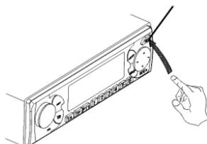
2. После откидывания передней панели потяните ее влево и выньте переднюю панель.
