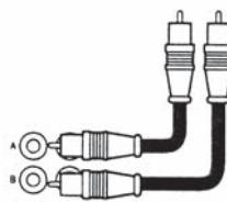
При прокладке сигнальных кабелей располагайте их на удалении от электропроводки автомобиля и кабеля питания усилителя во избежание наведения помех. Проложите питающие и сигнальные кабели по разные стороны автомобиля. Любой дополнительный кабель можно проложить зигзагообразно и ни в коем случае не со скручиванием в колышко.
