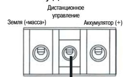
Подключите к клемме дистанционного управления головного устройства
