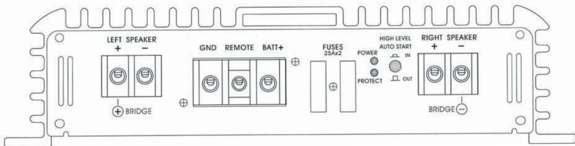
RA20 является двухканальным стереофоническим усилителем. Его можно использовать либо как стереофонический усилитель для широкополосных акустических систем, либо как монофонический усилитель для сабвуферов, включенных в мостовом режиме.
