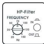
При установке переключателя **HP-filter** в положение **OUT** усилитель обеспечивает широкополосное воспроизведение. Если по каким-либо причинам вы захотите ограничить воспроизведение низких частот, то включите фильтр высоких частот. Обычно используется установка 60 – 80 Гц.
