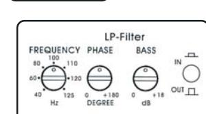
**Фильтр низких частот** пропускает только низкие частоты и блокирует высокие. Стандартной установкой является частота 70 – 90 Гц. При использовании усилителя с сабвуфером, переключатель должен быть установлен в положение IN. Задавайте для низкочастотного фильтра частоту 70 – 90 Гц.
