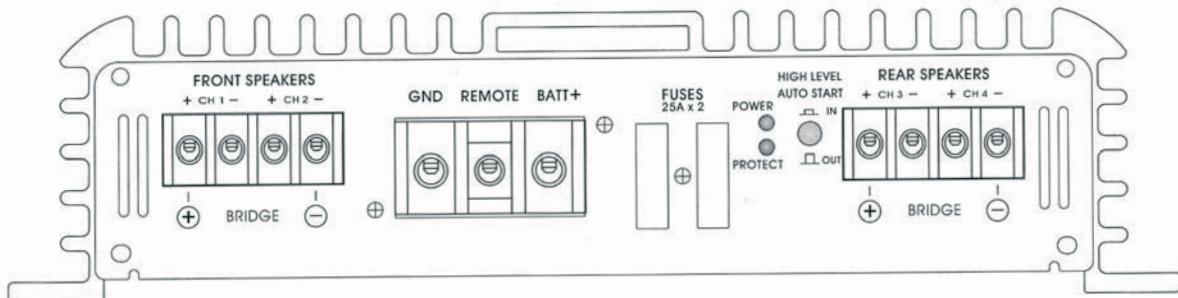
RA40 является четырехканальным стереофоническим усилителем. Его можно использовать либо как стереофонический усилитель с двумя парами широкополосных акустических систем, либо трехканальный усилитель с одной парой широкополосных акустических систем, работающих в стереофоническом режиме, и одного сабвуфера, включенного в мостовом режиме.
