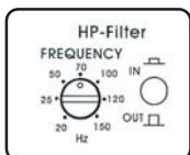
При установке переключателя **HP-filter** в положении **OUT** усилитель пропускает на акустические системы полный диапазон. Если по каким-либо причинам вы хотите ограничить воспроизведение самых низких частот, то включите переключатель **HP-filter**. Стандартной установкой в этом случае является частота 60 – 80 Гц.
