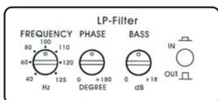
Переключатель **LP-filter** должен быть выключен (положение **OUT**).
