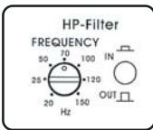
При установке переключателя **HP-filter** в положении **OUT** усилитель подает на акустические системы полный диапазон. Если по каким-либо причинам вы хотите ограничить воспроизведение самых низких частот, то установите переключатель HP-filter в положение IN. Стандартной установкой в этом случае является частота 60 – 80 Гц.
