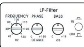
**Фильтр низких частот** пропускает только низкие частоты и блокирует высокие. Стандартной установкой является частота 70 – 90 Гц. При использовании усилителя с сабвуфером, переключатель должен быть в положении **IN**. Устанавливайте для низкочастотного фильтра частоту 70 – 90 Гц.
