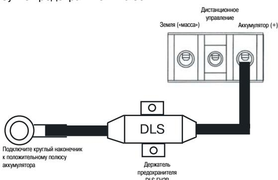
Подключите провод от держателя предохранителя к клемме усилителя, предназначенной для подачи +12 В от аккумулятора.
