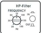
При установке переключателя **HP-filter** в положении **OUT** усилитель пропускает на акустические системы полный диапазон. Если по каким-либо причинам вы хотите ограничить воспроизведение самых низких частот, то включите переключатель **HP-filter** (положение **IN**). Стандартной установкой в этом случае является частота 60 – 80 Гц.
