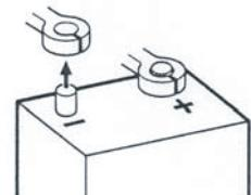
Если имеются установочные комплекты с различными проводами, то выбирайте комплект с самыми толстыми проводами – это улучшит качество звука и позволит подключить к проводам питания несколько усилителей. Используйте провод не тоньше 4 AWG (сечение 21 мм<sup>2</sup>).
