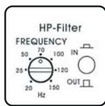
При установке переключателя HP-filter в положение OUT усилитель обеспечивает широкополосное воспроизведение. Если по каким-либо причинам вы захотите ограничить воспроизведение низких частот, то включите фильтр высоких частот. Стандартной используемой установкой является 60 – 80 Гц. Переключатель LP-filter должен быть в положении OUT.
