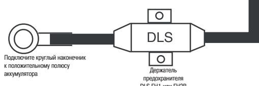
Подключите провод от держателя предохранителя к клемме усилителя, предназначенной для подачи +12 В от аккумулятора.
