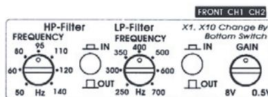
Каналы CH1 и CH2 содержат фильтры высоких (HP) и низких (LP) частот.
