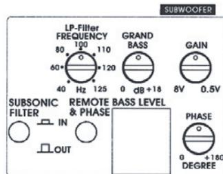
Канал CH5 содержит фильтр низких частот (LP) и инфразвуковой фильтр. Крутизна спада характеристики LP фильтра составляет 12 дБ/октаву, а инфразвукового фильтра – 18 дБ/октаву. Если вы не хотите ограничивать воспроизведение самых низких частот, то действие инфразвукового фильтра можно отключить.
