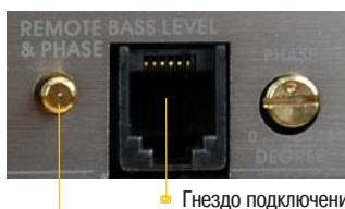
При включении дистанционной регулировки регулятор фазы на усилителе отключается. Дистанционная регулировка включается нажатием кнопки, расположенной слева от гнезда подключения кабеля.
