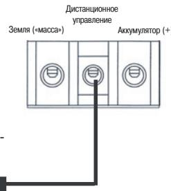
Подключите к клемме дистанционного управления головного устройства или к питанию привода антенны
