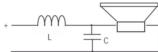
Для пассивного фильтра нижних частот 12 дБ ставят последовательно катушку индуктивности 10 мГн, а биполярный конденсатор емкостью 300 мкФ подключен параллельно. Частота среза кроссовера составляет 95 Гц.
