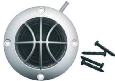
Просверлите отверстие в обшивке двери диаметром 46 мм / 1.77". Прикрепите динамик твитера к обшивке двери (или к другой поверхности, на которой вы хотите установить динамик) с помощью четырех длинных винтов.
